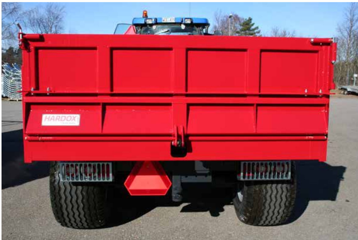
Bakläm undre K-Schakt 11.0, 80 cm hög stål målad
