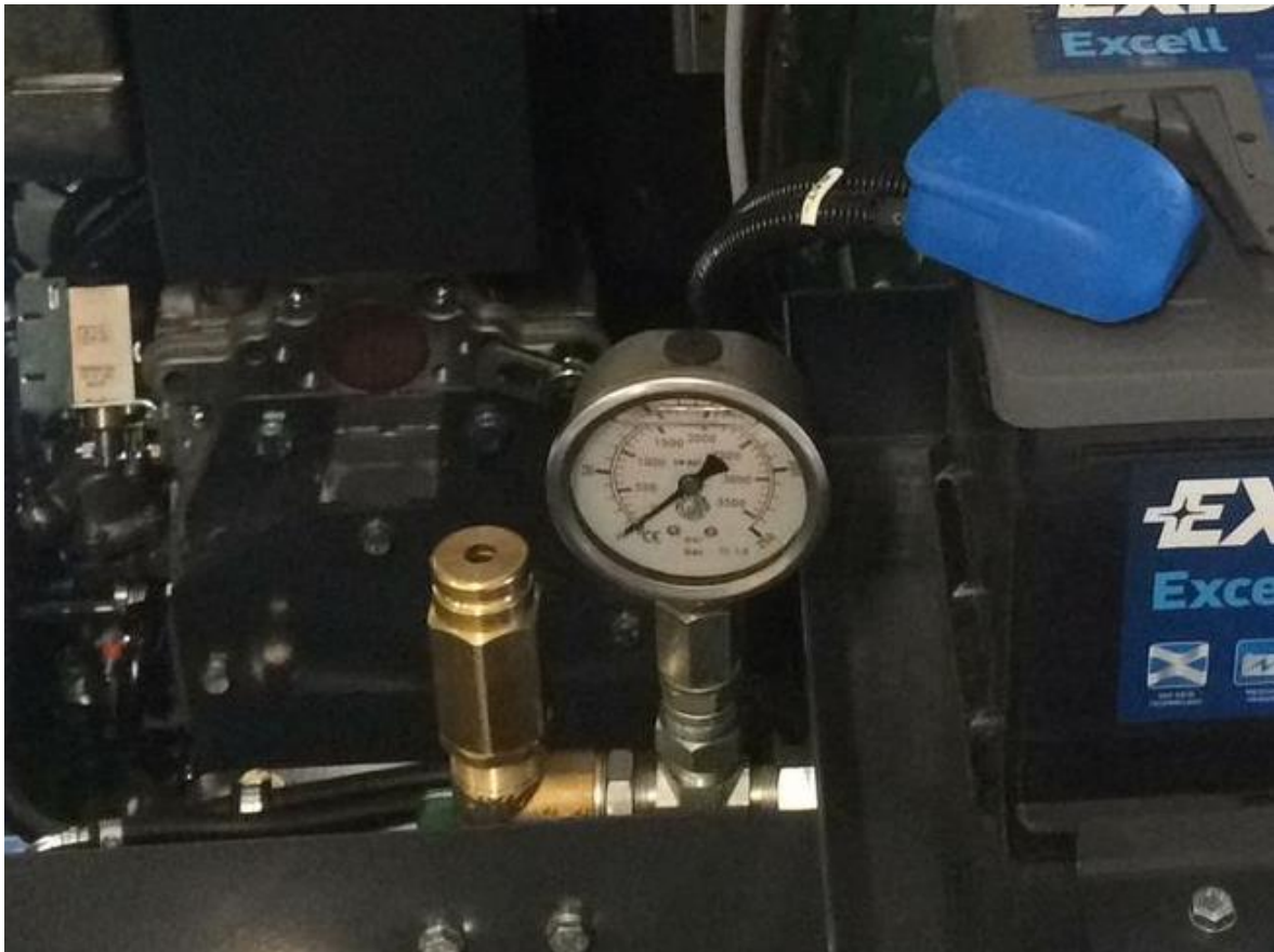
Bild 6. Säkerhetsventil och tryckmätare för ECO-läge
